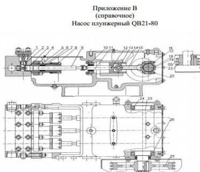
Рисунок В.1 - Схема насоса плунжерного QB21-80.
